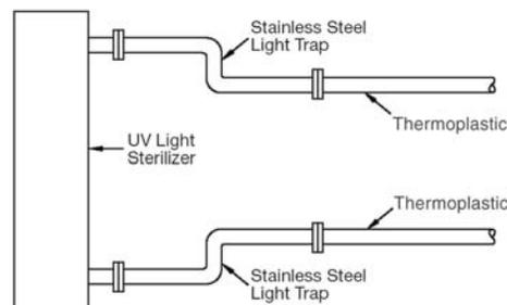
FIGURE 2.C UV LIGHT TRAP DESIGN
