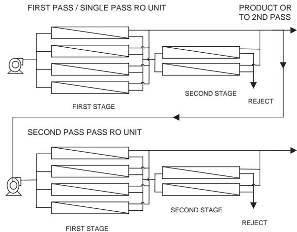
FIGURE 2.B SINGLE / DOUBLE PASS RO UNIT
